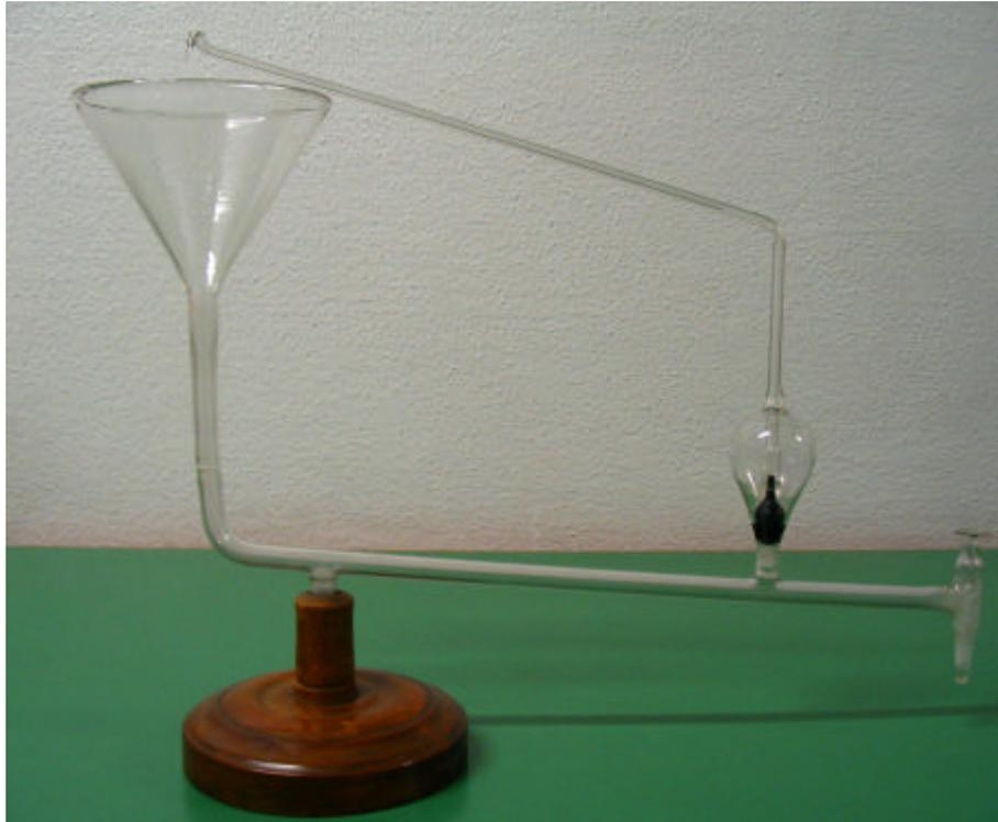
Se in un condotto percorso da acqua (o altro liquido) con velocità  $v$  viene bruscamente arrestato il flusso del liquido, la velocità passa improvvisamente dal valore  $v$  al valore  $0$ . L'energia
