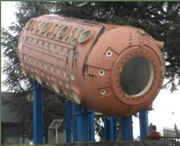
viene usata per visualizzare le tracce delle particelle ionizzanti che la attraversano. Lo strumento contiene un liquido in condizioni metastabili. Se una particella ionizzante attraversa il volume sensibile della camera, si provoca nel liquido un'ebollizione localizzata rilevando la traccia della particella con una successione di bollicine gassose. Es. rilevatore «Gargamelle» del CERN di Ginevra
