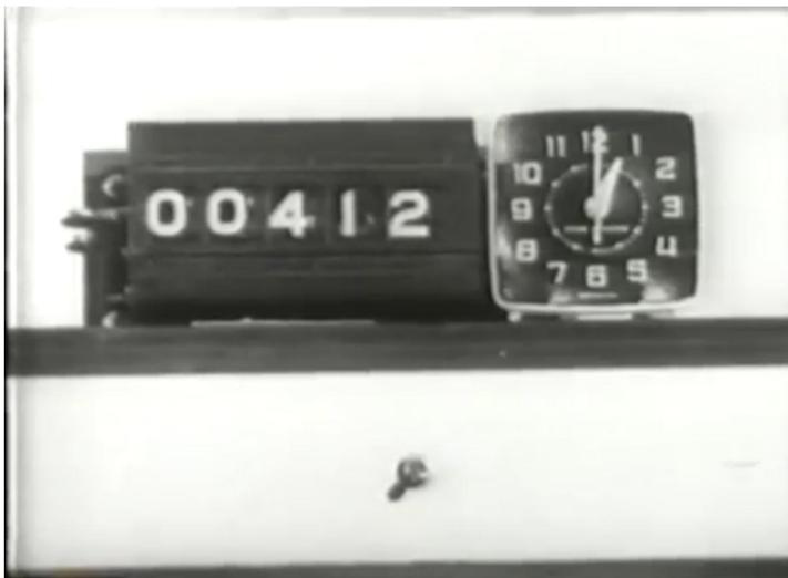
Abbiamo riportato il numero di mesoni sopravvissuti in funzione del tempo sulla tabella secondo il nostro orologio a decadimento di mesoni. 412 corrisponde a 0,7 microsecondi di tempo circa trascorso in volo.
