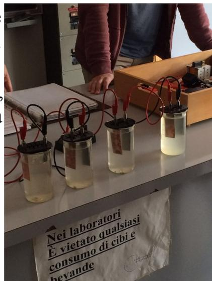
Si può osservare che il voltaggio delle pile in serie era pari a quasi 4 volte il valore da noi ottenuto (parte della differenza di potenziale si è disperso a causa della resistenza dei cavetti).
