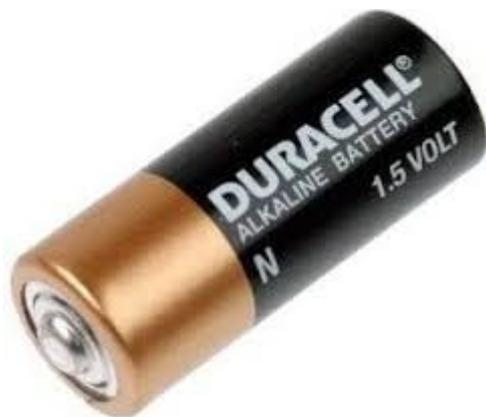
Allora fu riprogettata la pila alcalina, utilizzando un cilindro di acciaio che contiene il biossido in forma compattata e non più in pasta, un separatore inorganico imbevuto di idrossido di potassio, e lo zinco polverizzato con aggiunta di poco mercurio al centro della batteria, con un ago di acciaio che faceva da collettore per il polo negativo: era nata la pila alcalina.
