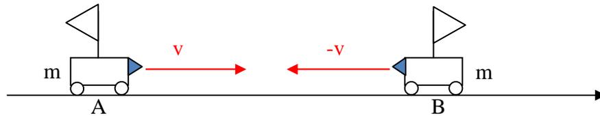
Sostituisco i valori delle velocità iniziali e delle masse nel sistema (sapendo che le velocità finali saranno due per ogni carrellino, ossia la situazione di partenza, dove cioè l'urto non è avvenuto, e quella con urto avvenuto):
