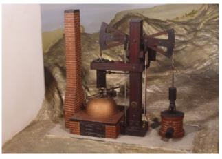
dello stantuffo con il contrappeso e si prolungava con una barra che, alzandosi e abbassandosi secondo il movimento dello stantuffo, azionava una pompa. Pur essendo poco efficiente, il motore di Newcomen si rivelò abbastanza pratico e venne largamente usato per pompare l'acqua fuori dalle miniere di carbone.
