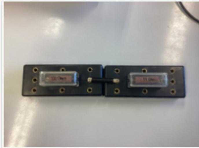
L'intensità di corrente è la stessa per ciascuna delle resistenze ed equivale a quella che fluisce nel circuito, mentre la differenza di potenziale totale è data dalla somma delle differenze di potenziale ai capi dei singoli resistori:
