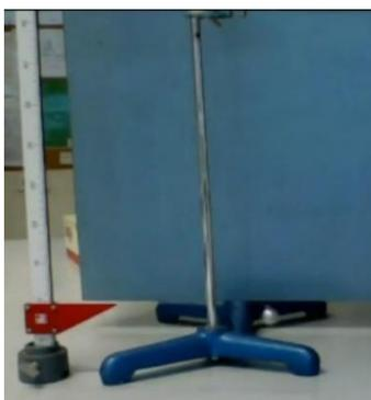
1. Per prima cosa abbiamo posizionato il pendolo sul banco di lavoro e, grazie all'asta millimetrata abbiamo misurato l'altezza dello strumento, compresa tra il baricentro della massa (una pallina) e la mezzadria dell'asta, per fare ciò abbiamo misurato la distanza tra il banco di lavoro e la pallina:  $h_0 = (9,8 \pm 0,1)$  cm e la distanza tra il banco di lavoro e la mezzadria dell'asta:  $h = (47,4 \pm 0,1)$  cm.
