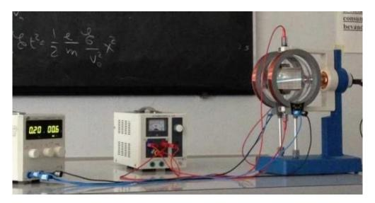
La lunghezza x delle armature delle armature del condensatore era di 0,07m. La distanza d fra le armature era di 0,034m.
