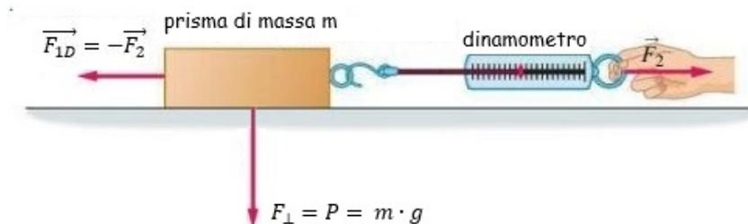
Nota la massa e quindi il peso del prisma e la forza di primo distacco, il coefficiente di attrito statico si determina con la formula:
