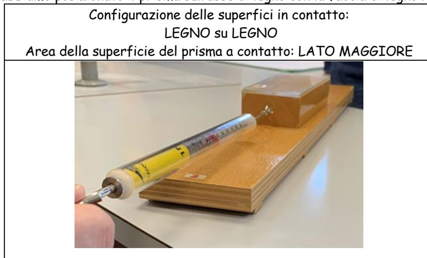
Abbiamo poi applicato manualmente la forza che viene misurata direttamente dal dinamometro.
