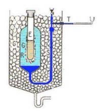
esempio è il calorimetro di Bunsen. Questo dispositivo è formato daun'ampolla a cui è saldata una provetta. Il calorimetro si basa sulla fusione del ghiaccio, ma la quantità di ghiaccio fuso siottiene dalla variazione di volume. E'costituito da un tubo di vetro, a pareti sottilissime, saldato ad un tubo di vetro di diametro maggiore, il quale termina inferiormente con un tubo pure di
