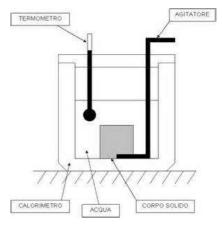
esempio è costituito dal **calorimetro delle mescolanze**, il quale è costituito da un vaso di Dewar in cui viene versata dell'acqua e poi la sostanza in esame; all'interno del calorimetro sono posti un termometro e un agitatore.Un vaso di Dewar è un contenitore che mantiene il suo contenuto isolato dell'ambiente esterno frapponendo con l'esterno delle
