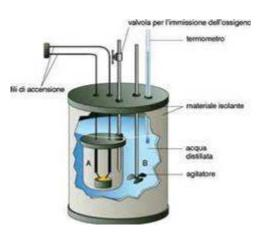
Mahler, con la quale viene determinato il calore di sostanze solide o liquide. Essa consiste in un piccolo recipiente di acciaio a pareti robuste, ermeticamente chiuso, in cui è posta una piccola capsula di porcellana contenente la sostanza in esame. Nel recipiente viene immesso ossigeno puro la
