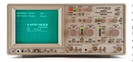
L'oscilloscopio è invece uno strumento di misura elettronico che, consente di visualizzare su un grafico bidimensionale l'andamento nel dominio del tempo dei segnali elettrici ed effettuare misure a letture diretta di tensione e periodo. Un oscilloscopio è
