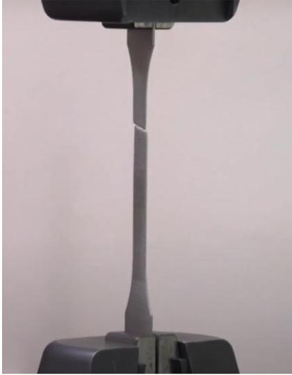
che i calcoli saranno automatici. Velocità traversa: 5mm al minuto. Viene azionata la macchina e compaiono i primi segni sul computer.
