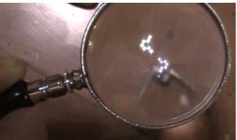
Abbiamo constatato che la lente ingrandisce la molla perché essa è posta ad una distanza dalla lente minore della distanza focale della lente, appunto, formando un'immagine virtuale ingrandita.
