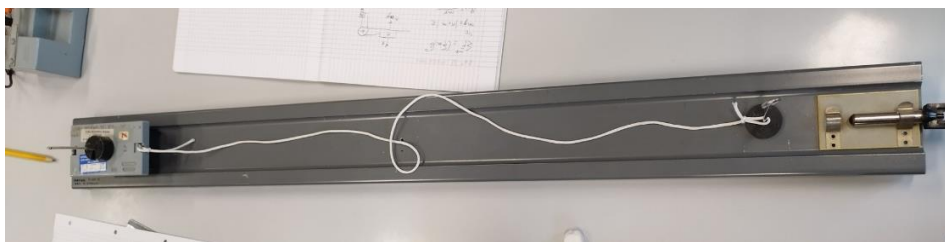
Il sistema formato da guida metallica, carrellino, spago, pesetti e portamasse, puleggia
