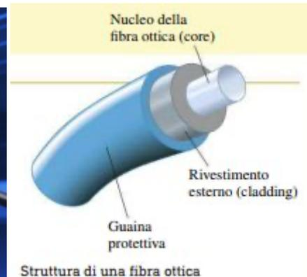
Il suo funzionamento avviene grazie al fatto che al suo interno avviene un fenomeno di riflessione totale: ogni singolo filamento imprigiona fasci di luce in quanto entrano con una incidenza maggiore dell'angolo limite che, sotto forma di impulsi, "rimbalzano" riuscendo a trasportare il segnale per lunghe distanze senza disperdere quasi nulla.
