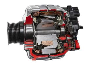
funziona grazie al concetto fondamentale dell'induzione elettromagnetica: per indurre una corrente in una bobina è necessario variare un flusso magnetico nel tempo all'interno di essa. L'oggetto che produce il campo magnetico si chiama induttore; il circuito che invece genera elettricità si chiama circuito indotto. Esistono due modi per ottenere questo risultato, quindi due tipi diversi di alternatore:
