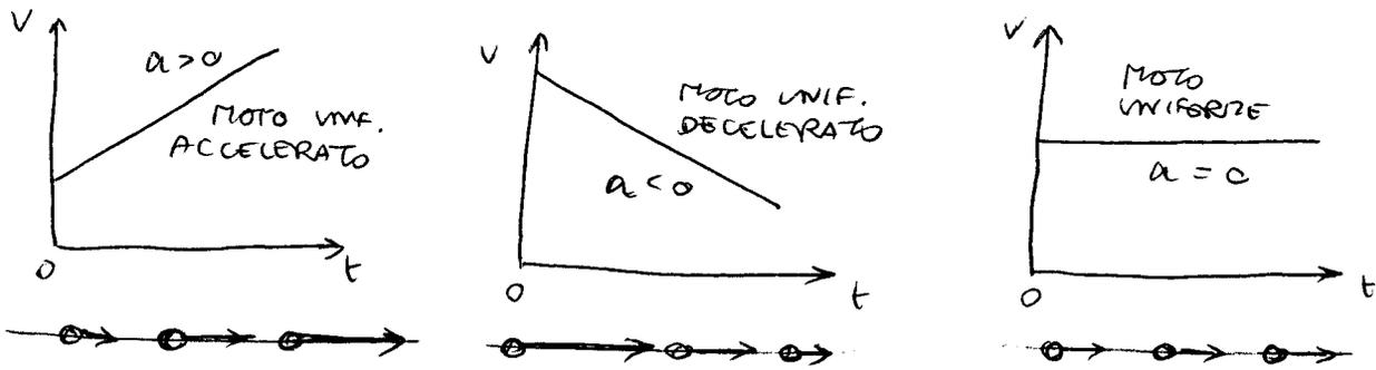
SE  $a = 0$ , SI TORNA AL MOTO RETTILINEO UNIFORME. LA PENDENZA NEL DIAGRAMMA TACHIMETRICO DÀ L'ACCELERAZIONE DEL PUNTO MATERIALE.
