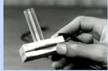
E' necessaria una sorgente di luce che illumina l'intercapedine tra le due lastre connesse con i fili alle 4 batterie che si possono regolare con una manopola da 1 a 4.
