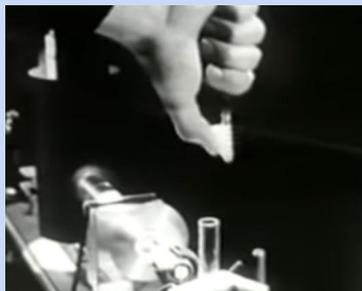
Queste scendono attraverso il foro del tubo fino ad arrivare nello spazio fra le lastre; al microscopio si può notare che queste sferette 'cadono' a velocità costante tirate dalla gravità.
