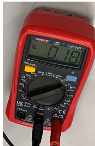
Multimetro impostato come voltmetro sensibilità 20 V
