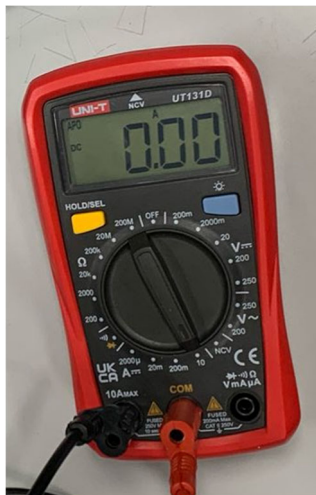
Multimetro impostato come amperometro sensibilità 10 A
