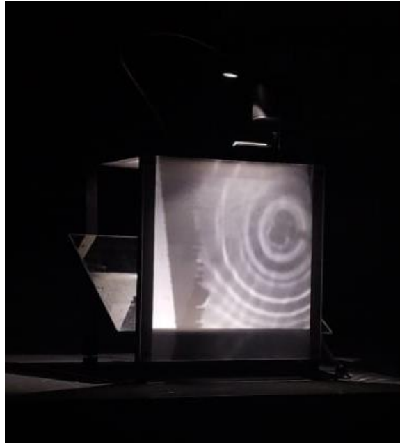
Percussore a pallina che genera onde sferiche con un ostacolo piano
