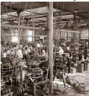
Esempio di settore produttivo che faceva uso della macchina motrice a vapore "centralizzata"
