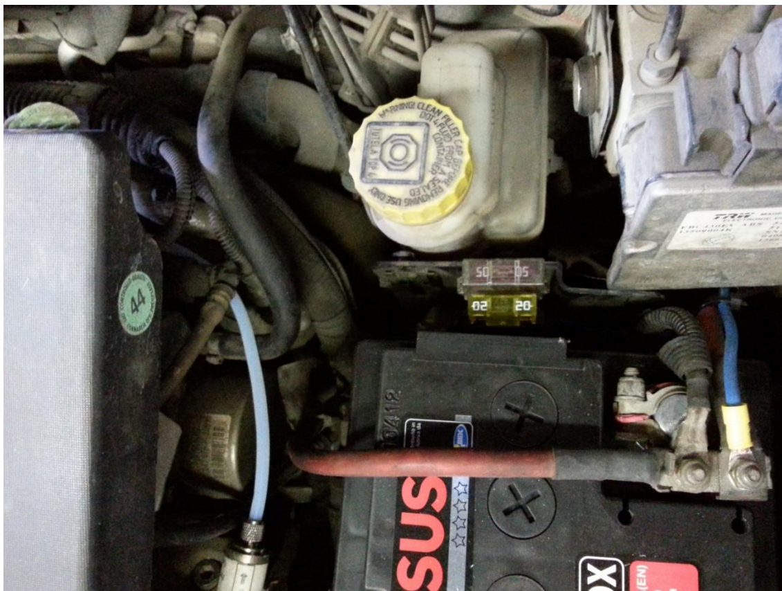
Figura 6.4 – Particolare del fusibile di alimentazione dell’impianto [22]
