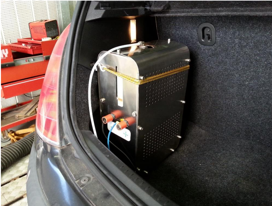
Figura 6.2 – cella elettrolitica posizionata nel bagagliaio [22]
